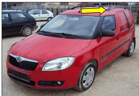
Sl.4.2.b. – krovni nosači kao dodatna oprema
