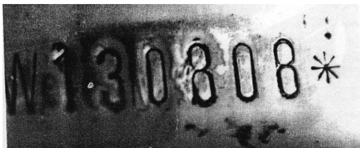
Sl.2 Deo falsifikovanog broja šasije ( vidi raspored, oblik i dubinu otiska brojeva )
