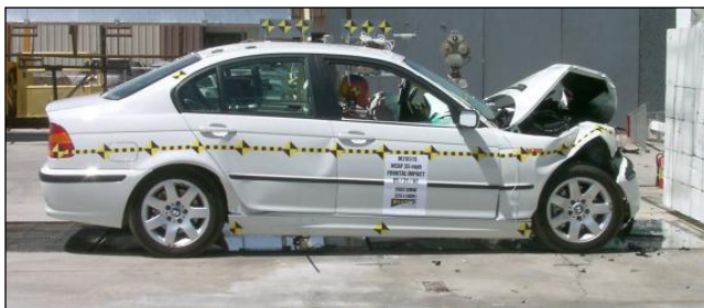
Slika 1. Nalet vozila BMW 325 I na čvrstu prepreku
