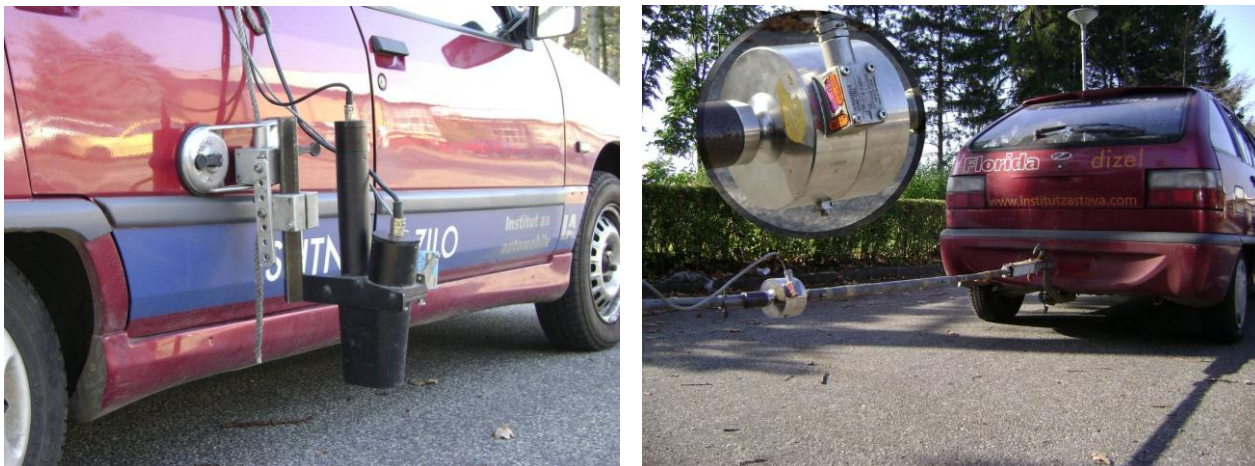
Slika 7. Merni sistem DATRON i Spreg vozila sa krutom rudom i davačem sile [1]
