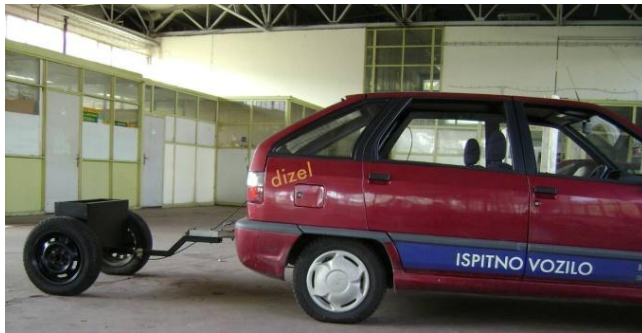
Slika 1. Uređaj za merenje trenja klizanja na ispitnom vozilu [1]
