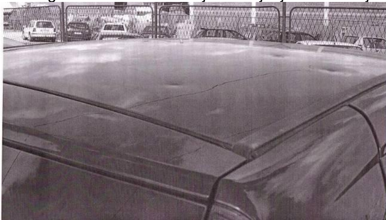
Sl. 7 Oštećenja krova vozila od udara grada
