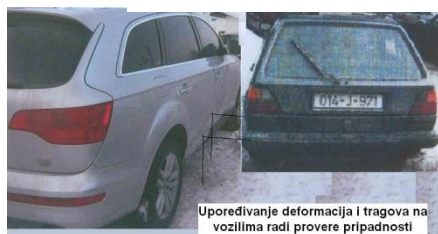
Upoređivanje oštećenih delova na vozilima od međusobnog kontaktiranja u sudaru
