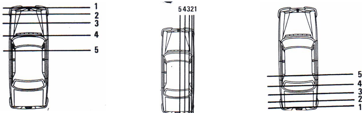
Sl.5 Stepen oštećenja
