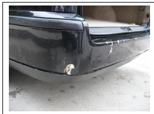
Sl. 5. Izgled oštećenog zadnjeg branika i izgled prethodnih popravki Umanjena vrednost novougrađenih delova zbog starosti motornog vozila.
