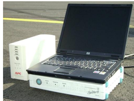
Slika 2. Merna oprema korišćena za određivanje koeficijenta trenja klizanja [1]
