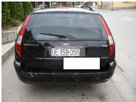
Sl. 5. Izgled oštećenog zadnjeg branika i izgled prethodnih popravki Umanjena vrednost novougrađenih delova zbog starosti motornog vozila.
