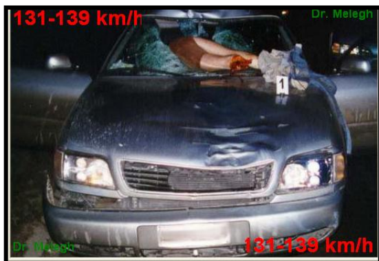
Slika 8. Deformacije za naletnu brzinu 131-139 km/h Slika 9. Deformacije na vozilu Audi
