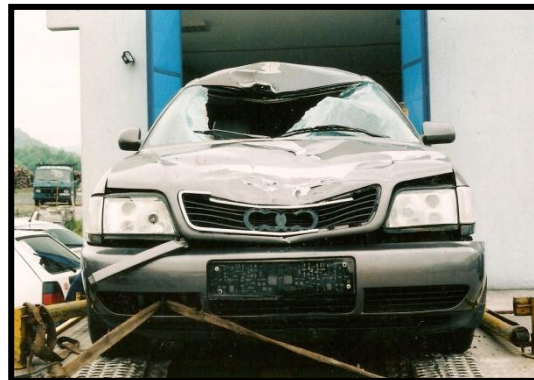
Slika 8. Deformacije za naletnu brzinu 131-139 km/h Slika 9. Deformacije na vozilu Audi
