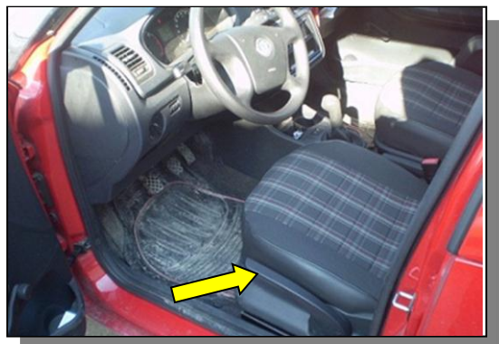
Sl. 4.2.e. – sjedište vozača podesivo po visini kao dodatna oprema
