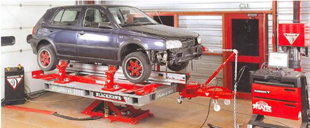
Sl.14 Sto za merenje i ispravljanje oštećene karoserije automobila
